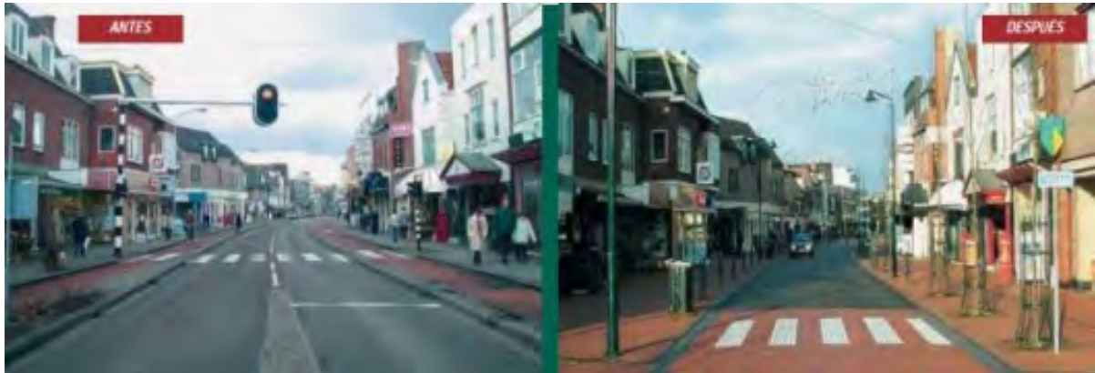
Figura 8 - Via compartilhada em Haren, Holanda, antes e depois da remoção do sinal.
